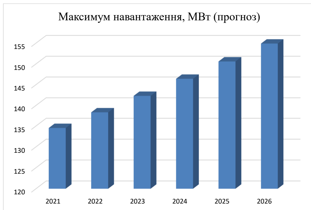
Рис. 2.4. Прогноз максимальних електричних навантажень підстанцій, МВт
